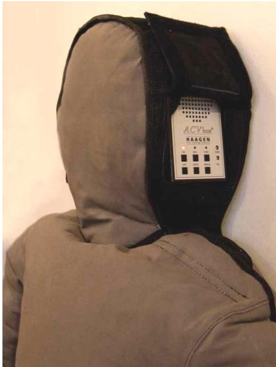
Abbildung 6: ACV Box im Kopf des SmartDummy™ Thermal
